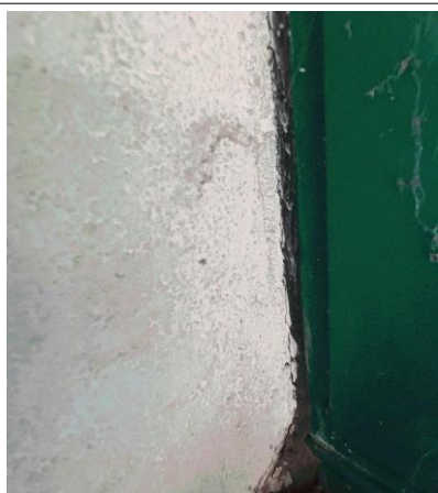
Prélèvement - P071 : BAT 112 - LA BLANCHISSERIE / RDC / STOCKAGE LINGERIE 1039 - Joint- (Absence d'amiante)
