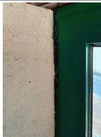
Prélèvement - P070 : BAT 112 - LA BLANCHISSERIE / RDC / STOCKAGE LINGERIE 1039 - Joint- (Absence d'amiante)
