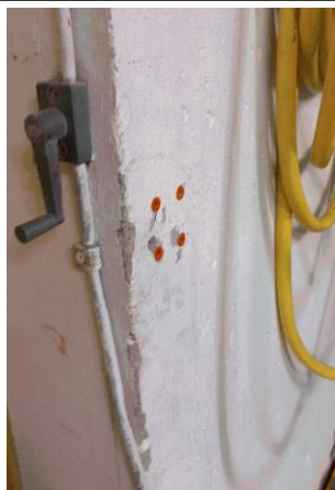
Prélèvement - P056 : BAT 112 - LA BLANCHISSERIE / RDC / LOCAL LESSIVE 1040 - Enduit- (Absence d'amiante)
