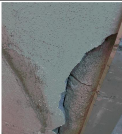
Prélèvement - P039 : BAT 112 - LA BLANCHISSERIE / RDC / ABRI VEHICULE 2 1021 - Enduit- (Absence d'amiante)
