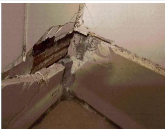
Prélèvement - P011 : BAT 112 - LA BLANCHISSERIE / RDC / VESTIAIRES FEMMES 1003 / DOUCHE 1007 - Colle de plinthe- (Absence d'amiante)
