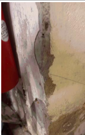
Prélèvement - P055 : BAT 112 - LA BLANCHISSERIE / RDC / LOCAL LESSIVE 1040 - Enduit- (Absence d'amiante)
