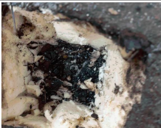
Prélèvement - P088 : BAT 112 - LA BLANCHISSERIE / EXTERIEUR / TOITURE TERRASSE - Pare-vapeur- (Absence d'amiante)
