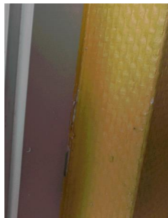
Prélèvement - P004 : BAT 112 - LA BLANCHISSERIE / RDC / DETENTE 1002 - Joint de porte- (Absence d'amiante)
