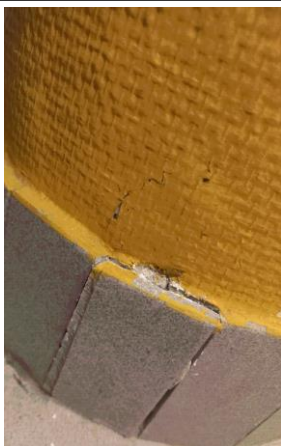
Prélèvement - P031 : BAT 112 - LA BLANCHISSERIE / RDC / DEGAGEMENT 1 1019 - Colle de plinthe- (Absence d'amiante)
