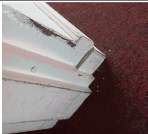
Prélèvement - P076 : BAT 112 - LA BLANCHISSERIE / ETAGE 1 / SALLE DE REUNION 2001 - Bande de plaque de plâtre- (Absence d'amiante)
