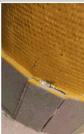
Prélèvement - P033 : BAT 112 - LA BLANCHISSERIE / RDC / DEGAGEMENT 1 1019 - Joint de plinthe- (Absence d'amiante)
