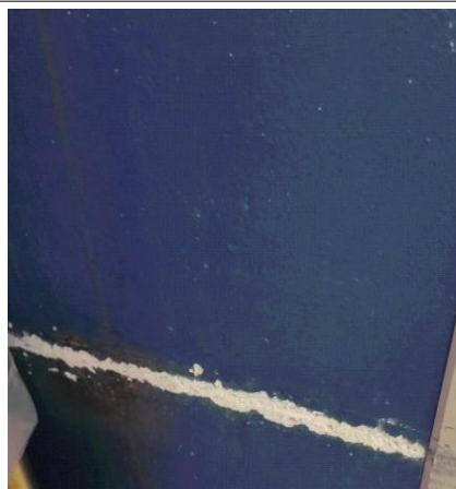
Prélèvement - P040 : BAT 112 - LA BLANCHISSERIE / RDC / ABRI VEHICULE 2 1021 - Enduit- (Absence d'amiante)
