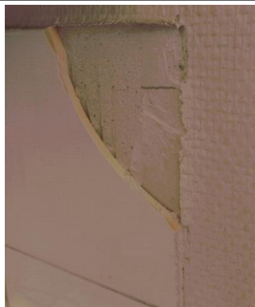
Prélèvement - P062 : BAT 112 - LA BLANCHISSERIE / RDC / TOILETTE 1035 - Colle de faïence- (Absence d'amiante)
