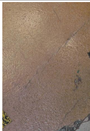
Prélèvement - P038 : BAT 112 - LA BLANCHISSERIE / RDC / ABRI VEHICULE 2 1021 - Colle- (Absence d'amiante)
