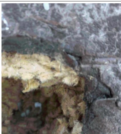
Prélèvement - P090 : BAT 112 - LA BLANCHISSERIE / EXTERIEUR / TOITURE TERRASSE - Complexe d'étanchéité asphalté- (Absence d'amiante)
