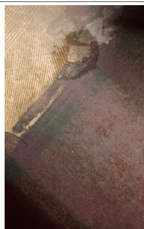
Prélèvement - P072 : BAT 112 - LA BLANCHISSERIE / ETAGE 1 / BUREAU DIRECTION 2007 - Colle- (Absence d'amiante)
