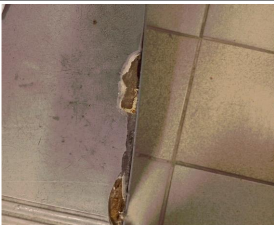
Prélèvement - P029 : BAT 112 - LA BLANCHISSERIE / RDC / DEGAGEMENT 1 1019 - Colle- (Absence d'amiante)
