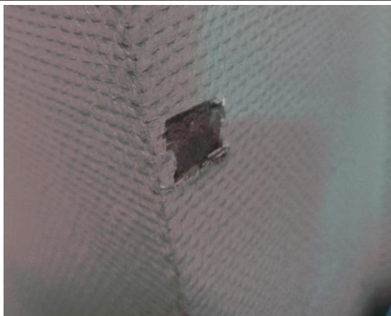
Prélèvement - P074 : BAT 112 - LA BLANCHISSERIE / ETAGE 1 / BUREAU 2008 - Enduit- (Absence d'amiante)
