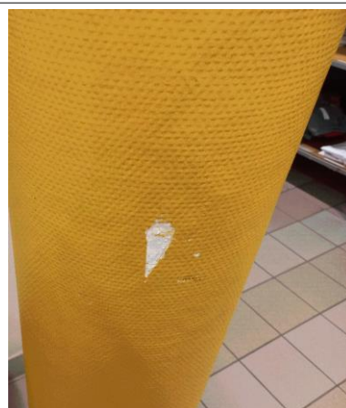
Prélèvement - P022 : BAT 112 - LA BLANCHISSERIE / RDC / DEGAGEMENT 1 1019 - Enduit- (Absence d'amiante)
