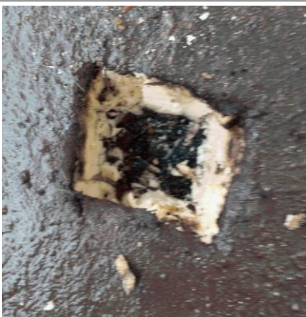
Prélèvement - P087 : BAT 112 - LA BLANCHISSERIE / EXTERIEUR / TOITURE TERRASSE - Complexe d'étanchéité asphalté- (Absence d'amiante)
