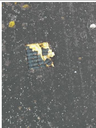
Prélèvement - P091 : BAT 112 - LA BLANCHISSERIE / EXTERIEUR / TOITURE TERRASSE - Complexe d'étanchéité asphalté- (Absence d'amiante)
