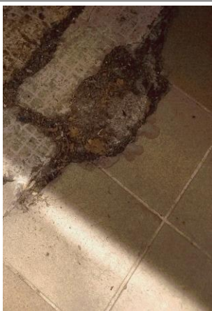
Prélèvement - P059 : BAT 112 - LA BLANCHISSERIE / RDC / SAS 1 1036 - Colle de carrelage- (Absence d'amiante)
