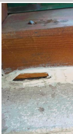
Prélèvement - P063 : BAT 112 - LA BLANCHISSERIE / RDC / BUREAU LINGERIE 1038 - Joint- (Absence d'amiante)
