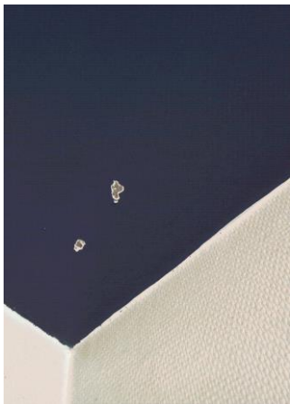
Prélèvement - P079 : BAT 112 - LA BLANCHISSERIE / ETAGE 1 / BUREAU 2008 - Enduit- (Absence d'amiante)
